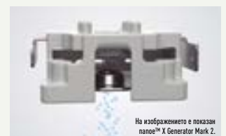
На изображението е показан nanoe™ X Generator Mark 2. Не се изисква поддръжка или подмяна. nanoe™ X е решение без филтър, което не се нуждае от поддръжка, тъй като електродът за атомизация е обгърнат с вода по време на процеса на генериране и е изработен от титан.
