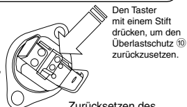
Zurücksetzen des Überlastschutzes (10)
