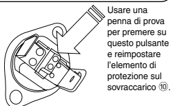
Come reimpostare l'elemento di protezione sul sovraccarico ⑩
