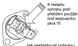
Jak restartovat ochranu proti přetížení ⑩
