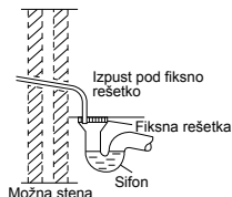
Risba napeljave odvodne cevi na prosto
