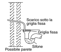
Illustrazione della guida del tubo di scarico verso l'esterno
