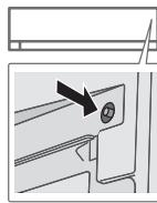
Utilizado quando o controlo remoto está mal colocado ou avariado. Levantar o painel frontal:
